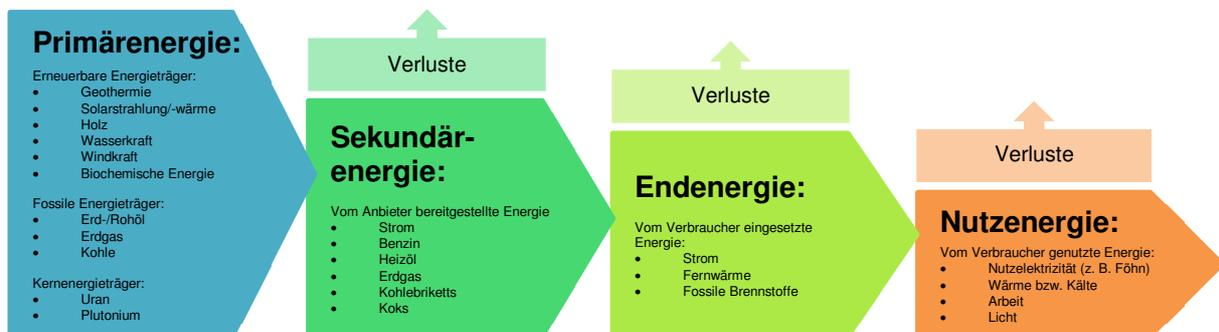
Abbildung 7: Energieumwandlung von Primärenergie zu Nutzenergie (16 S. 41ff; 15)
